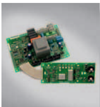
Микропроцессорная плата управления котла
